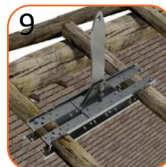
9 Travetti con interasse massimo 85cm, interasse 21° n°1 UNITH3/D n°2 KT90 n°4 BR12-05 n°8 DAD12A n°8 ROND12
