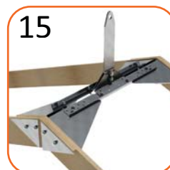
15 Travatura con interasse massimo 125cm n°1 UNITH3/B n°1 KT90 n°2 SSPEC n°16 DAD12A n°16 ROND12 n°4 BR12-05
