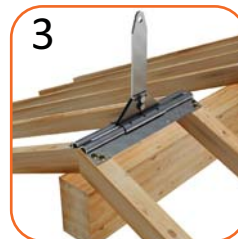
3 Travetti con interasse 75cm inclinazione 0/45° n°1 UNITH3/E80 n°8 VITLEG
