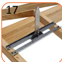
17 Travetti con interasse massimo 115cm, inclinazione 21cm n°1 UNITH3/D n°1 KT120 n°8 VITLEG
