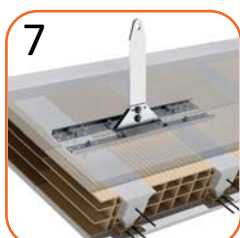
Falda inclinata 21° interasse massimo 70cm
