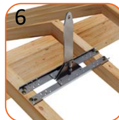
6 Travetti con interasse massimo 85 cm inclinazione 21° n°1 UNITH3/D n°1 KT90 n°8 VITLEG
